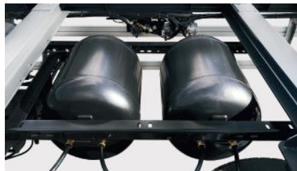
Luftbehälter für Bremsen und Pneumatiksysteme.
