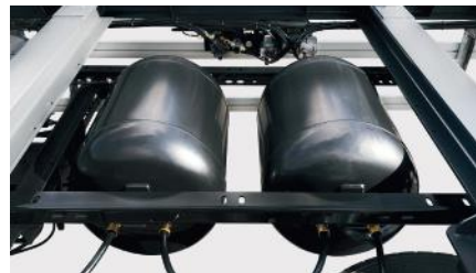
Luftbehälter für Bremsen und Pneumatiksysteme.
