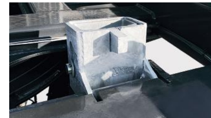
Mechanische Blockierung der Containerrolle
