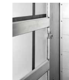
Lattentaschen und Zurrösen in der vorderen Eckkrüme.
